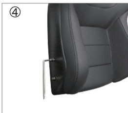
4 Odkręć Odkręć cztery fabryczne śruby z tyłu.
