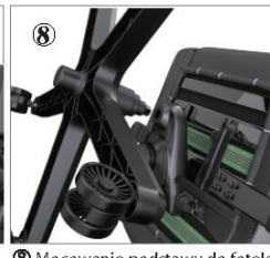
8 Mocowanie podstawy do fotela Włóż tłok do otworu w regulatorze, aby połączyć podstawę z fotelem.
