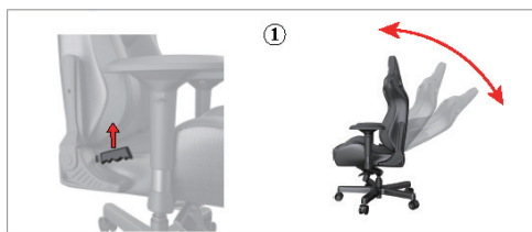
1 Odchylenie oparcia do tyłu Pociągnij dźwignię po prawej stronie fotela i odchyl oparcie dożądanego kąta.
