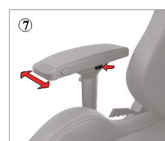
7 Regulacja podłokietnika 3 Naciśnij przycisk i przesun podłokietnik w lewo i w prawo.
